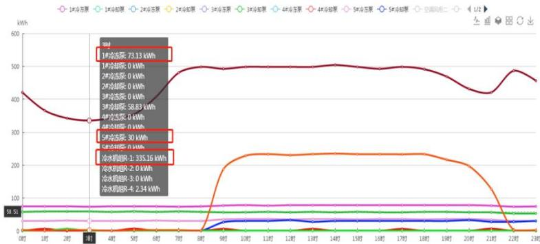
图 4-14 某建筑空调水系统“一机多泵”运行现象(单位: kWh)
